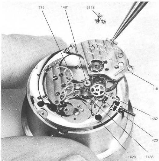
8.4.6 Lubrifier (long pivot+extrémité du pivot court) et mettre en place le pignon de seconde au centre 275.
