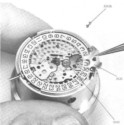
8.4.10 Lubrifier le tenon et poser la roue intermédiaire de quantième 2543. Mettre en place et fixer la plaque de maintien de l'indicateur de quantième 2535 par ses deux vis (52535).
